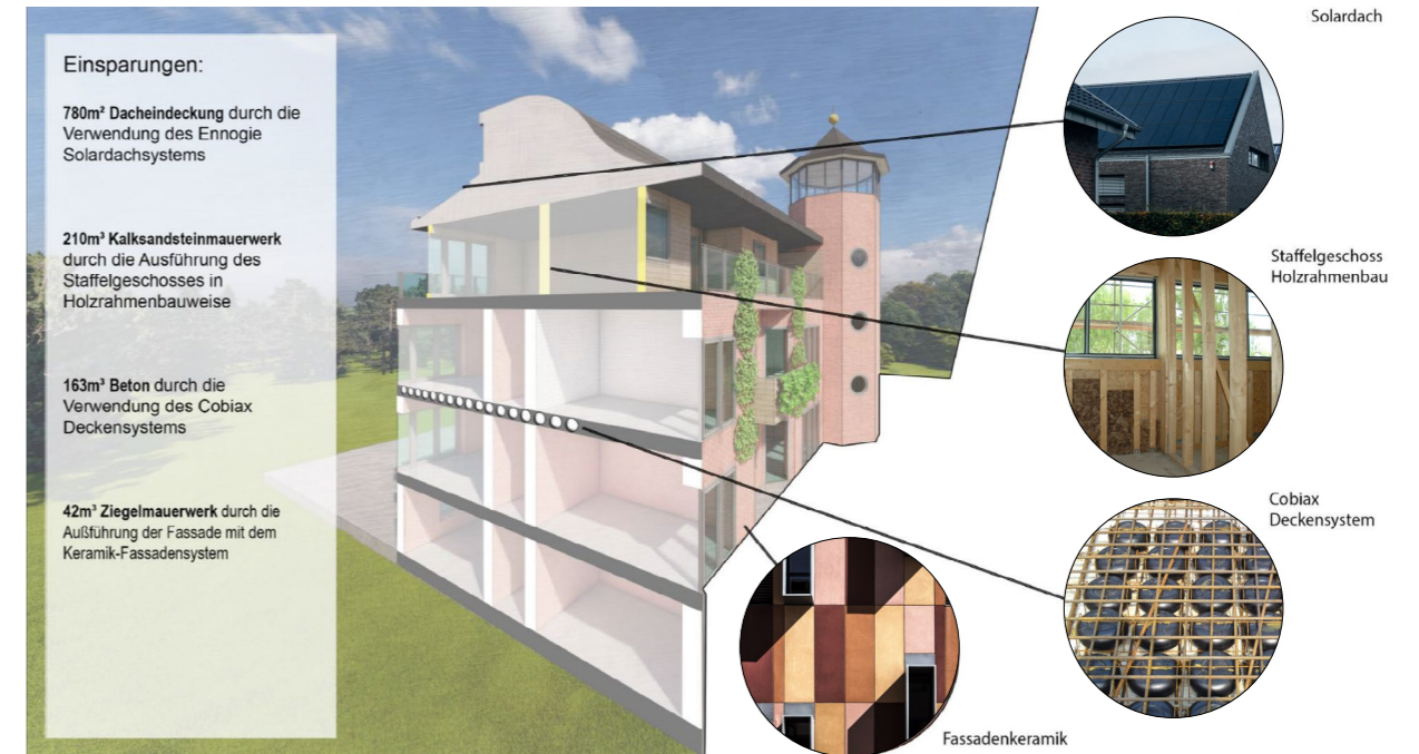
11 Einsparungen durch die Optimierungsvorschläge im Materialkonzept, basiert auf studentischen Arbeiten
