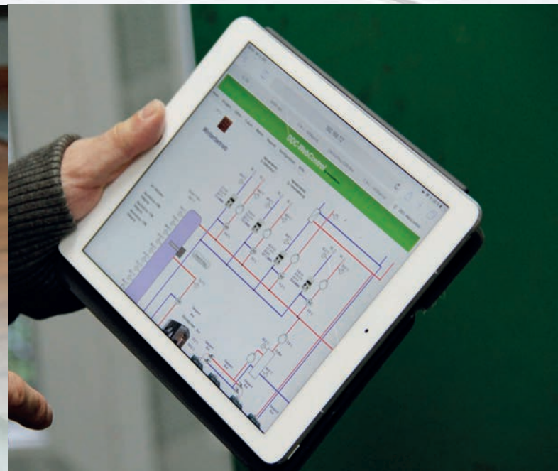
84 Zentrale Überwachung und Steuerung der Heizung
