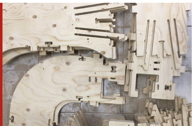
Abb. 10: CNC gefräste Bauteile
